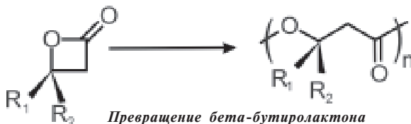
Превращение бета-бутиролактона в поли(бета)гидроксибутират
